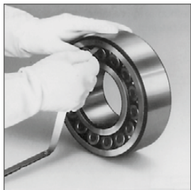
Fig. 1: Comprobación del juego radial interno del rodamiento en la mesa de trabajo.
