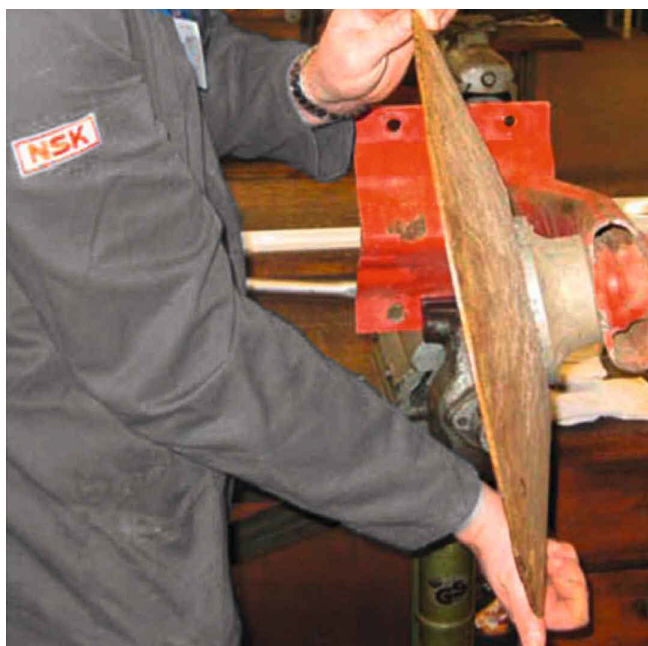
Un employé NSK dépose le moyeu du bras de la machine.
