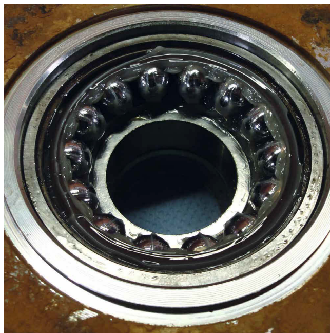
Après avoir démonté le roulement, aucune trace de terre/boue n'a été trouvée à l'intérieur du roulement ni dans le lubrifiant.
