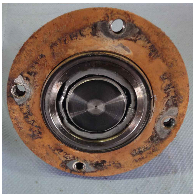
L'image montre qu'il n'y a aucune trace de contamination ni de rouille au-delà du joint torique.
