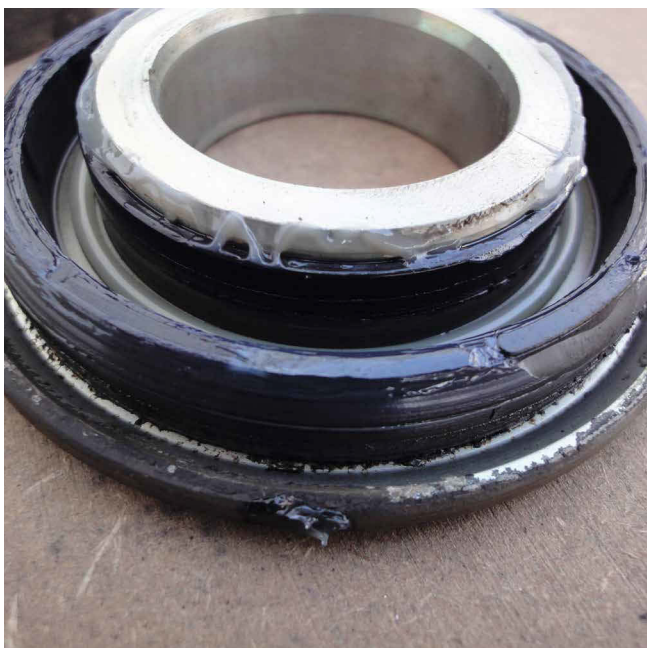
La boue n'a pas pu traverser le joint cassette. Le joint est en parfait état.
