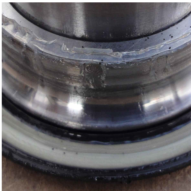
Les chemins de roulement ne présentent aucun signe de dommage ni d'usure.
