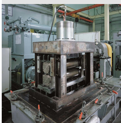
Banc d'essai pour les roulements des rouleaux de guidage de machines de coulée continue
