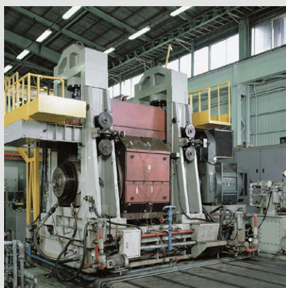
Banc d'essai pour les roulements des cylindres d'appui de laminoirs
