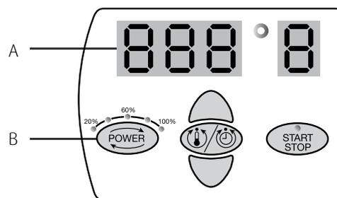
A) Il display principale mostra il tempo di riscaldamento o la temperatura di riscaldamento impostati:
