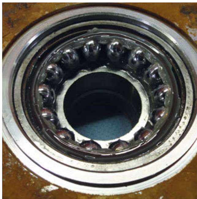
Po rozmontowaniu łożyska, ani wewnątrz łożyska, ani smar nie były zabrudzone.
