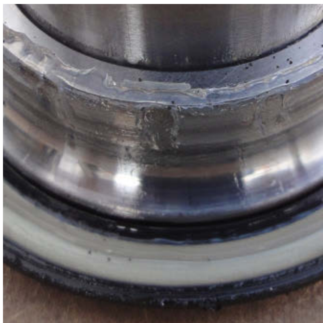
Brak śladów uszkodzeń lub zużycia na bieżniach.
