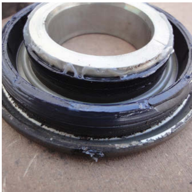
Bруд nie był w stanie przedostać się za uszczelnienie kasetowe. Uszczelka jest w doskonałym stanie.
