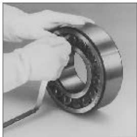
Rys. 1. Sprawdzanie luzu łożyska na stole roboczym
