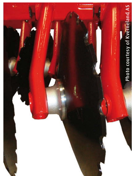
Рисунок 3: Испытание подшипникового узла посредством мытья под давлением на протяжении 200 часов. В конце испытания не было обнаружено никаких признаков попадания воды внутрь кассетного уплотнения.
