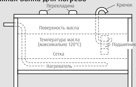
Рис. 4: Масляная ванна для нагрева
