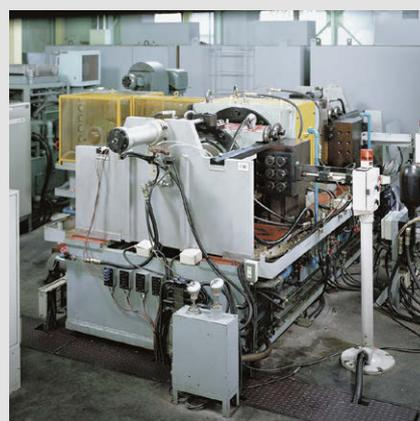
Испытательный стенд для подшипников, применяемых в рабочих валках прокатных станов
