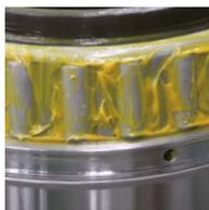
Водостойкая смазка для закрытых подшипников для прокатных валков
