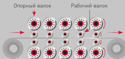
Подшипники NSK с применением смазки AQGRD прослужили в 2 раза дольше, чем стандартные подшипники для валков в условиях негативного воздействия попадания воды, что равнозначно бесперебойному производству 1 млн тон стали.
