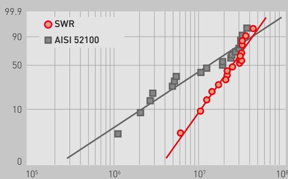
Результаты испытания на долговечность с приложением осевой нагрузки
