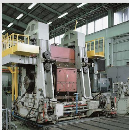
Испытательный стенд для подшипников, применяемых в опорных валках прокатных станов
