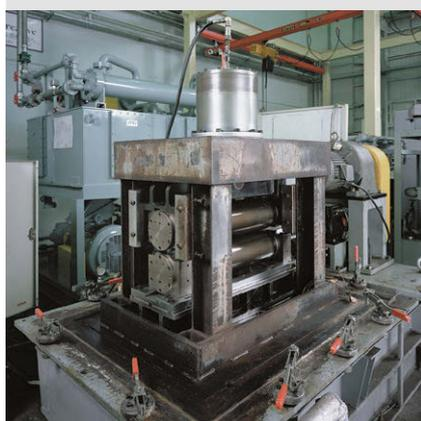
Испытательный стенд для подшипников, применяемых в направляющих роликах МНЛЗ
