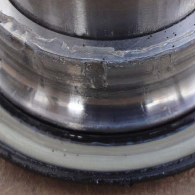
Yuvarlanma yollarında, hasar veya aşınma işareti yoktur.
