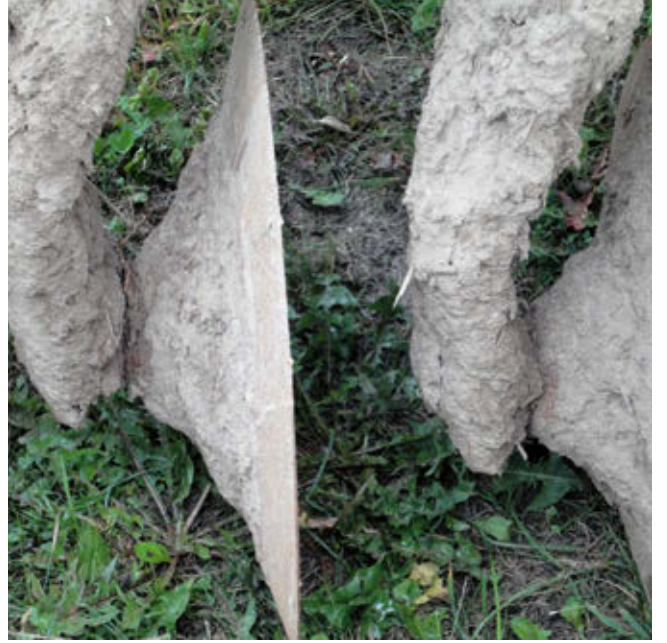
Sıvı gübre kullanımı sonrasında kirlenen diskaronun tipik görüntüsü.
