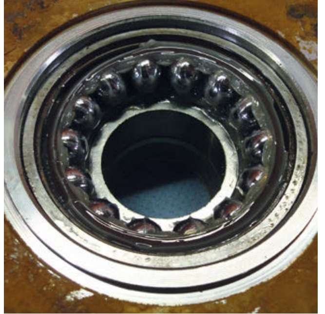
Rulman söküldüğünde, rulman veya yağlayıcı içerisinde kir tespit edilmemiştir.
