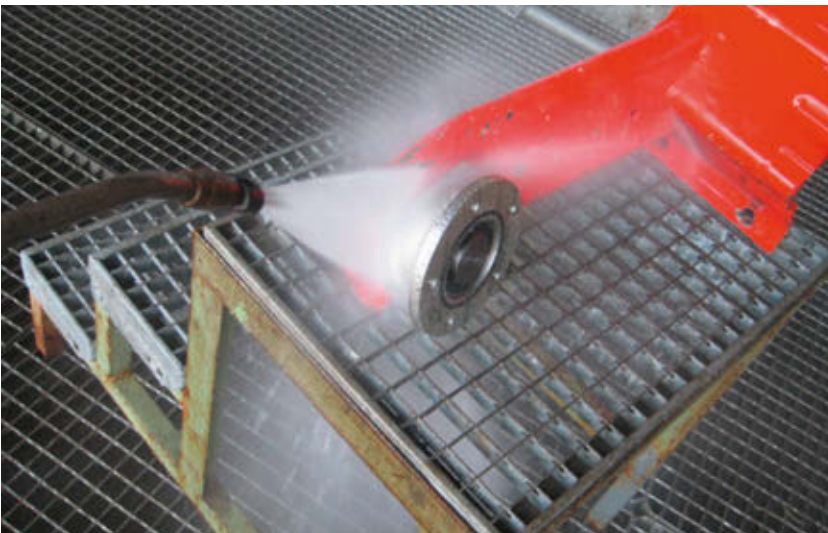
Şekil 3: 200 saat boyunca su jeti kullanılarak test edilmiştir.
