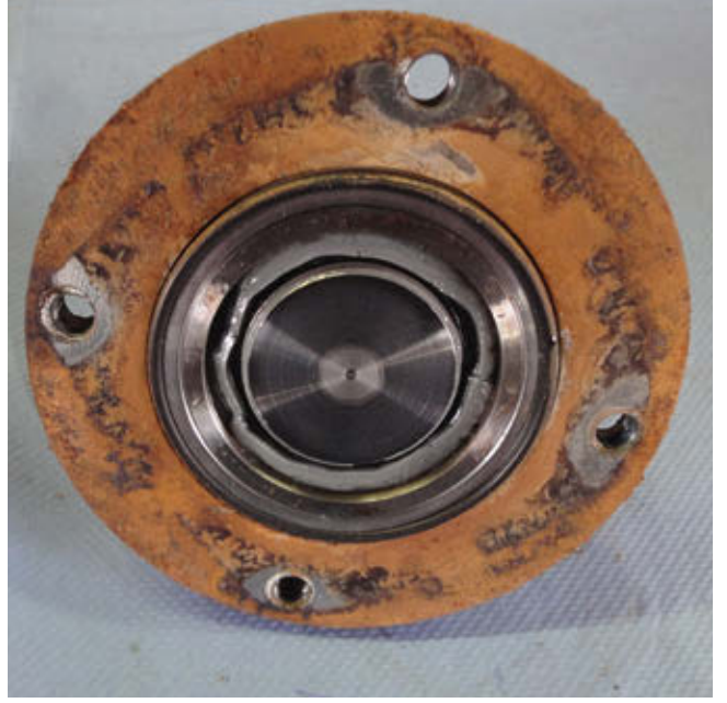
Resimde O-ring arkasında herhangi bir kontaminasyon veya paslanma olmadığı görülmektedir.
