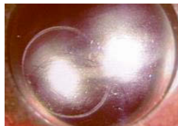
Bogenförmiger Kratzer auf der Kugel
