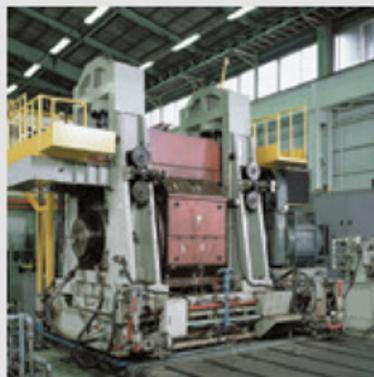
Prüfstand für die Wälzlager von Sützwälzen
