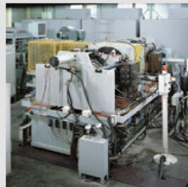
Prüfstand für die Wälzlager von Arbeitswalzen
