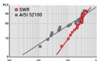
Auswertung der Betriebslebensdauer mittels Axiallebensdauerprüfung
