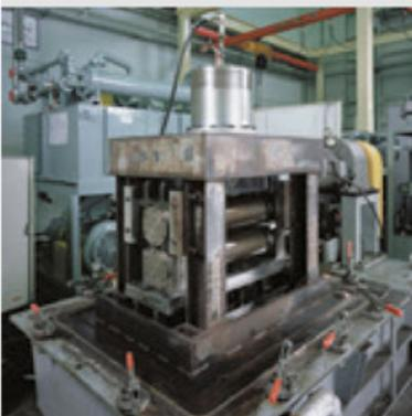
Prüfstand für die Wälzlager einer Strangführungsrolle
