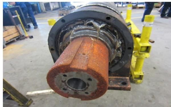
↑ SWR-Rollenlager und Gehäuse
