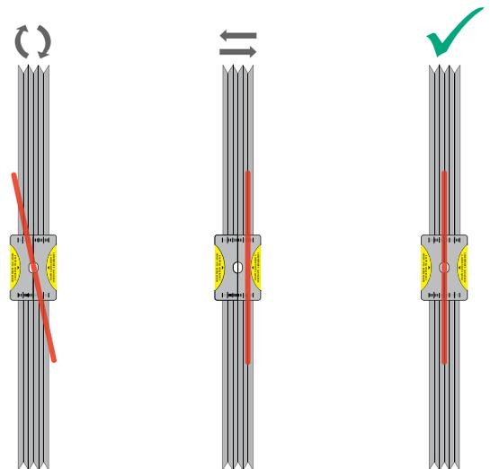
Las unidades LAB-Set se montan muy fácilmente en las poleas. La sonda con resorte encaja en el centro de la ranura de la correa. Los imanes industriales integrados permiten encajar perfectamente las unidades en la polea. Los equipos opcionales permiten alinear máquinas accionadas mediante correa de distribución.
