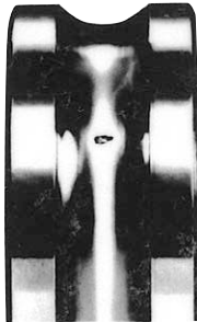
Fig. 5.1 Ejemplo de descamación
