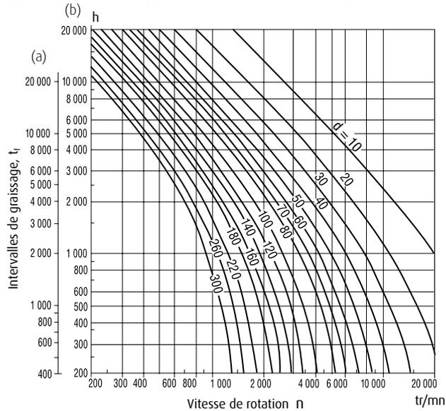
(2) Rlts à Rouleaux Coniques, Rlts à Rouleaux Sphériques
