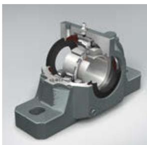
Les corps de palier en deux parties peuvent être utilisés avec des roulements auto-aligneurs à deux rangées de billes ou avec des roulements à rouleaux sphériques HPS. Plusieurs options d'étanchéité sont disponibles.
