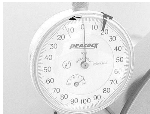
Fig. 1.11 Impostazione del calibro GN
