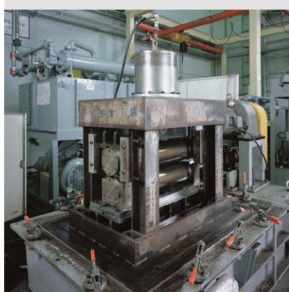
Stanowisko testowe łożysk używanych w rolkach prowadzących maszyn do ciągłego odlewania
