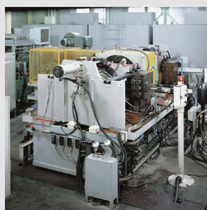
Stanowisko testowe łożysk używanych w walcach oporowych walcarek
