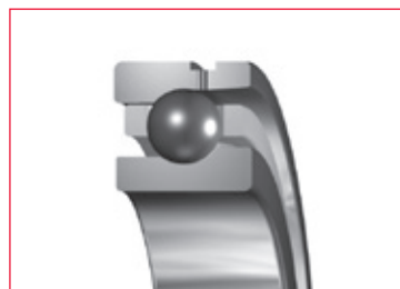
Kształt łożyska zaprojektowany specjalnie do uzupełniania smaru
