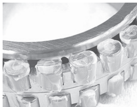
Rys. 1.23 Łożysko walcowe nasmarowane smarem
