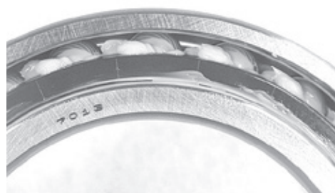
Rys. 1.23 Łożysko walcowe nasmarowane smarem
