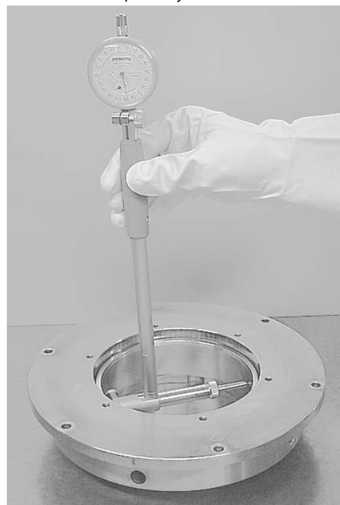
Рис. 1.11 Регулировка вписанного диаметра калибра GN
