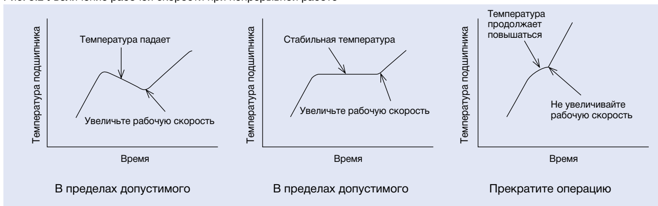
Рис. 3.2 Увеличение рабочей скорости при непрерывной работе
