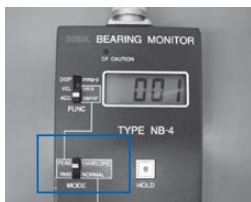
Записывание вибраций, вызванных царапиной внутри подшипника (ENVELOPE)
