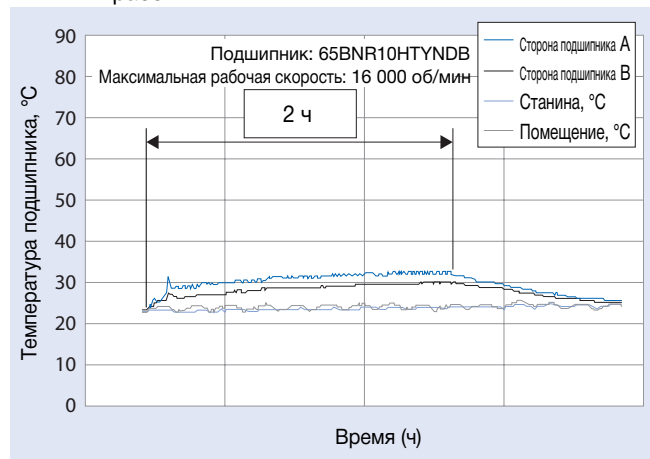
Рис. 3.3 Изменение температуры при прерывистом режиме работы
