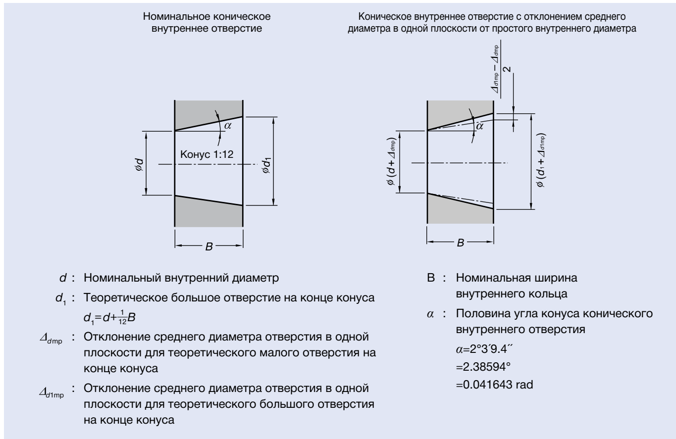
Рис. 7.3 Допустимые отклонения конического внутреннего отверстия
