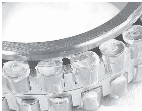
Рис. 1.20 Наполненный смазкой цилиндрический роликовый подшипник
