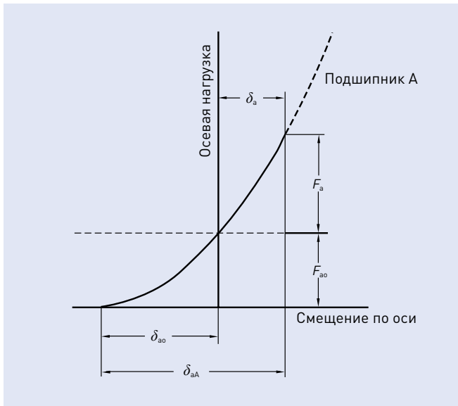
Рис. 4.8 Сравнение жесткости и преднатяга
