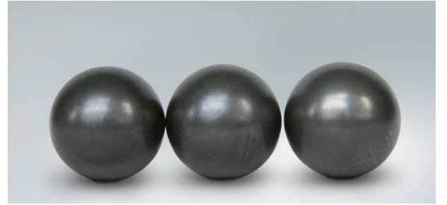
Resim 15.4 Parça: Bilyalı rulmanın bilyaları Bulgu: Elektriksel korozyon tüm bilya yüzeyini kaplayan koyu bir renge sahiptir
