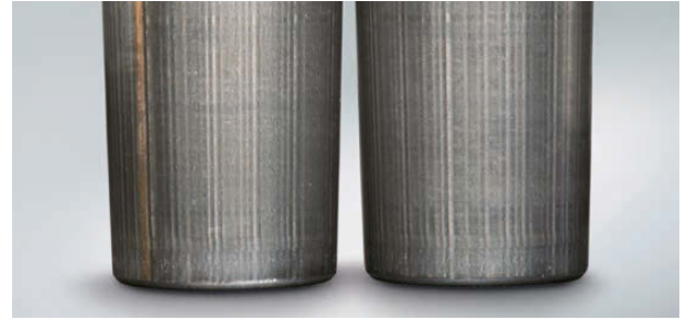
Resim 15.2 Parça: Resim 15.1 Konik makaralar Bulgu: Yuvarlanma yolu yüzeyinde çizgi desenli bir korozyon oluşur
