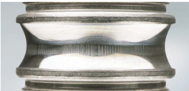
Resim 15.5 Parça: Sabit bilyalı bir rulmanın iç bileziği Bulgu: Yuvarlanma yolu yüzeyinde yivler meydana gelir (yüksek frekans)
