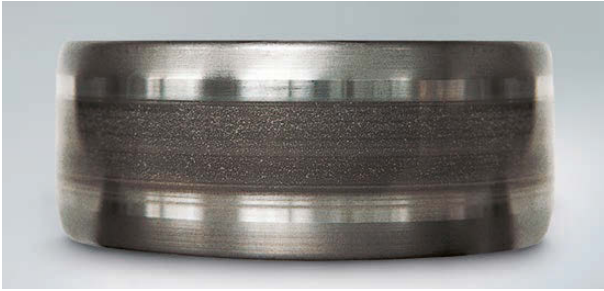
Resim 15.3 Parça: Silindirik makaralı bir rulmanın iç bileziği Bulgu: Yuvarlanma yolu yüzeyinde çukurcuklarla birlikte elektriksel korozyon kayış deseni
