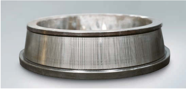
Resim 15.1 Parça: Konik makaralı bir rulmanın iç bileziği Bulgu: Yuvarlanma yolu yüzeyinde çizgi desenli bir korozyon oluşur
