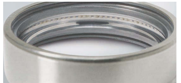
Resim 15.6 Parça: Sabit bilyalı bir rulmanın dış bileziği Bulgu: Yuvarlanma yolu yüzeyinde yivler meydana gelir (yüksek frekans)
